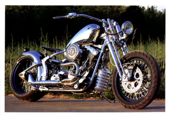
Dieser verchromte Traum war einmal eine Night Train. Von der blieb aber nur der Rahmen unangetastet. Den mitschwingenden Heckfender und die meisten anderen Parts dieses luftigen Beach Cruisers fertigte man bei Dr. Mechanik selbst.
